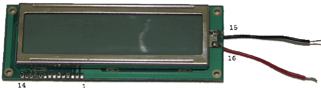
Figura 4.1. LCD 2x16 bazat pe HD44780 (față).
